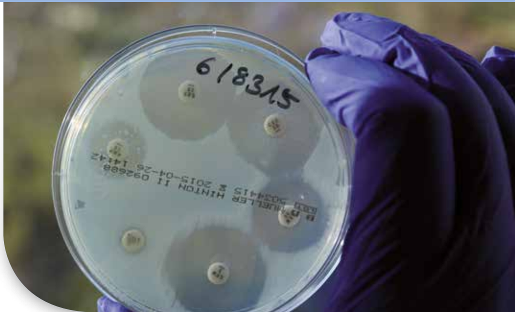
Abb: Antibiotika-Empfindlichkeitstestung mittels Agardiffusionstest
